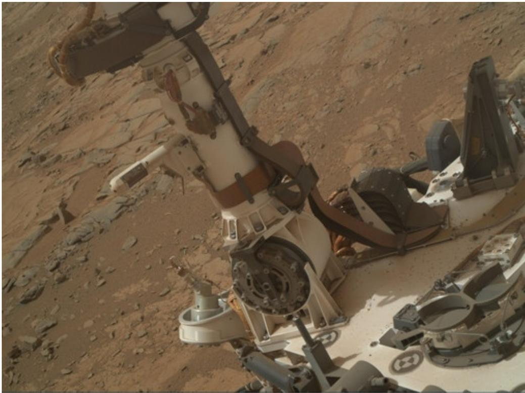
*El instrumento REMS, cuyos datos han servido para sugerir la presencia de salmueras líquidas en Marte, se sitúa en el mástil del rover Curiosity. (Foto: NASA/JPL-Caltech/MSSS)*
